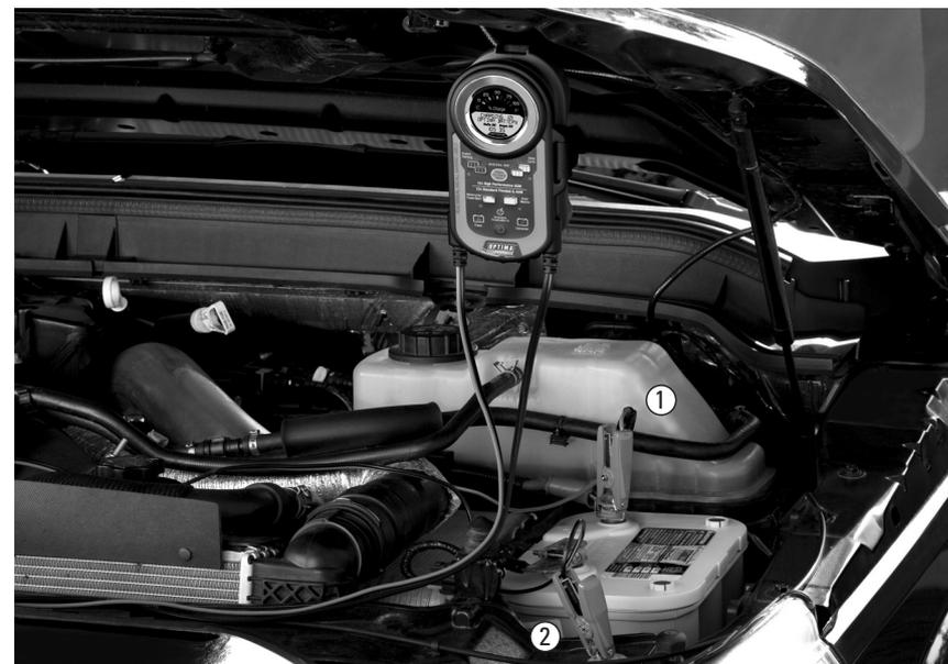
*Illustré : connexions typiques des pinces de chargements c.c. pour un bilan de précharge (avec moteur arrêté), un chargement ou seulement le maintien d'une batterie à pleine charge avec les pinces de chargement c.c. dans un véhicule.*
