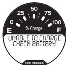
Vérifiez la tension de la batterie avec le bilan de précharge. Si la tension est supérieure à 12,0 volts, relancez le chargeur une fois. N'effectuez cette opération qu'une fois. Si cela échoue encore, retournez la batterie au concessionnaire pour vérification. Pour les applications de batteries à décharge profonde, nous suggérons le Digital 1200 conçu pour une récupération améliorée, un chargement plus rapide et la prolongation de la durée de vie des batteries profondément déchargées.
