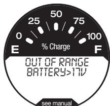
La tension de la batterie est élevée. Vérifiez la connexion possible d'une autre batterie (enlever la batterie supplémentaire). Vérifiez qu'il n'y a pas d'autre chargeur ou de source de maintien connectés ou activés. Enlevez si l'un ou l'autre est présent.
